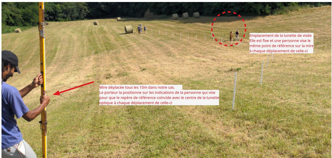
Utilisation du niveau optique pour piqueter tous les 10m
