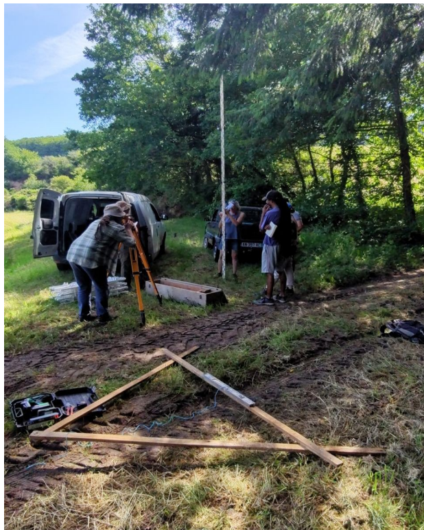
Assemblage du niveau égyptien et test du niveau optique
