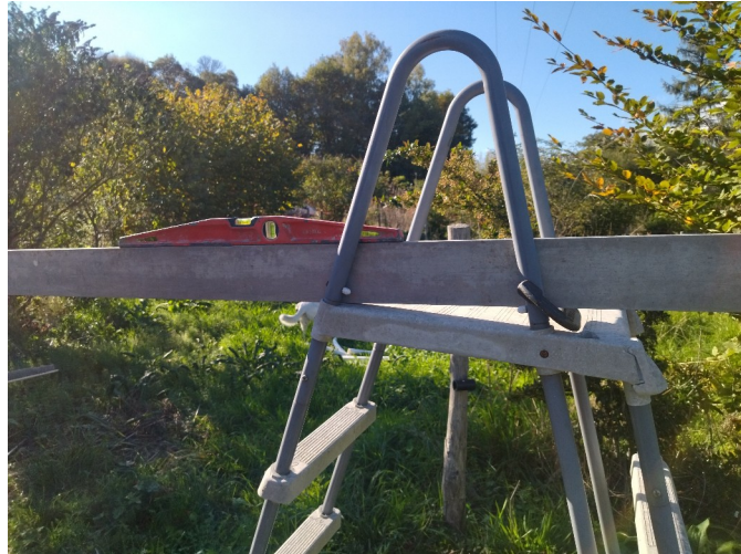
Pour déterminer la hauteur séparant deux éléments éloignés
